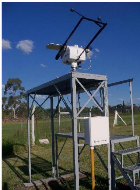
Eppley 8-48 "Black and White" sombreado por una esfera, montados ambos sobre un seguidor solar Kipp&Zonen SOLYS 2 controlado por GPS. Ver Figura 25.
