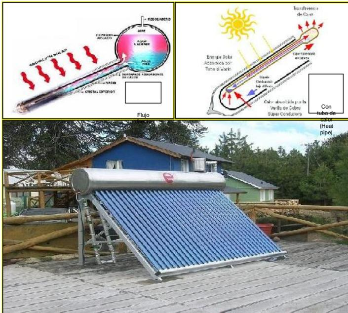
Figura 10. Calefactores solares con tubos de vacío.
